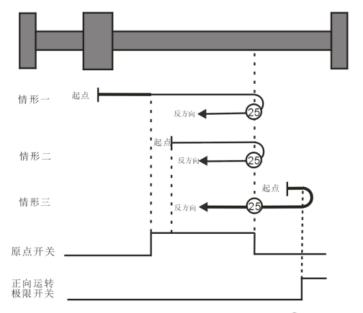
取决于原点开关、正向运转极限开关的原点回零,上图中的表示25原点回零模式25
