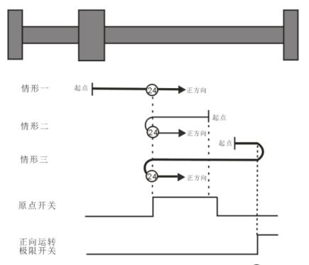
取决于原点开关、正向运转极限开关的原点回零,上图中的表示24原点回零模式24
