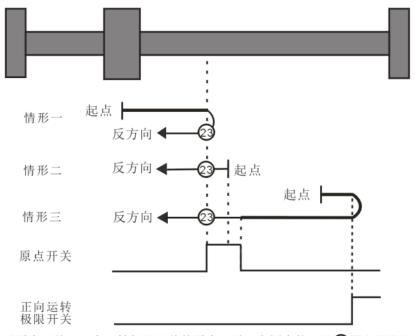
取决于原点开关、正向运转极限开关的原点回零,上图中的表示23原点回零模式23
