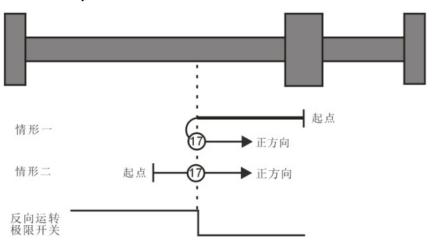
取决于反向运转极限开关的原点回零,上图中的表示(7)原点回零模式17
