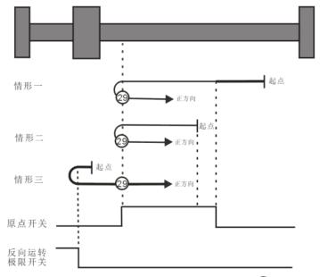
取决于原点开关、反向运转极限开关的原点回零,上图中的表示②原点回零模式29
