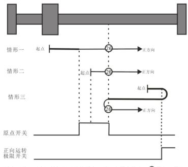
取决于原点开关、正向运转极限开关的原点回零,上图中的表示26原点回零模式26
