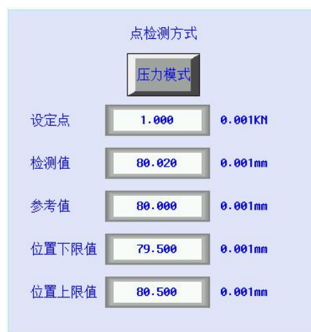
图 5.8-4 点检测方式压力模式-OK
