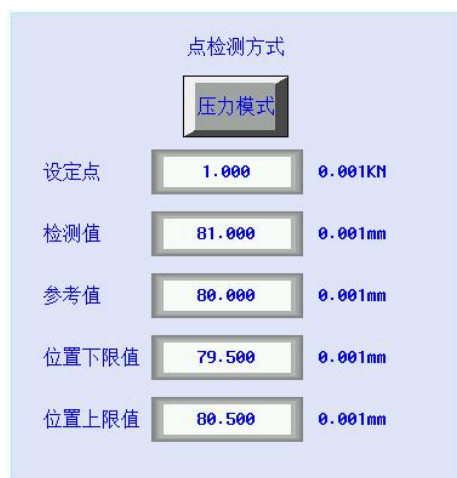
图 5.8-3 点检测方式压力模式-NG
