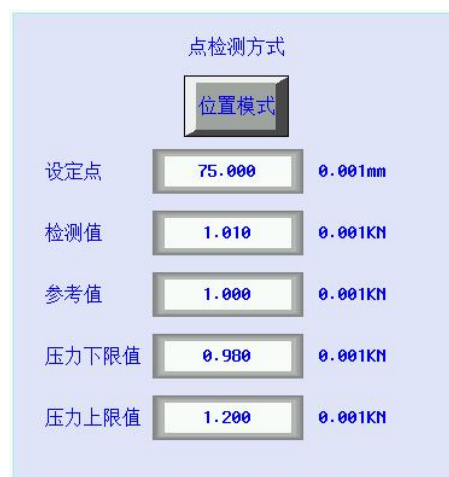
图 5.8-2 点检测方式位置模式-OK
